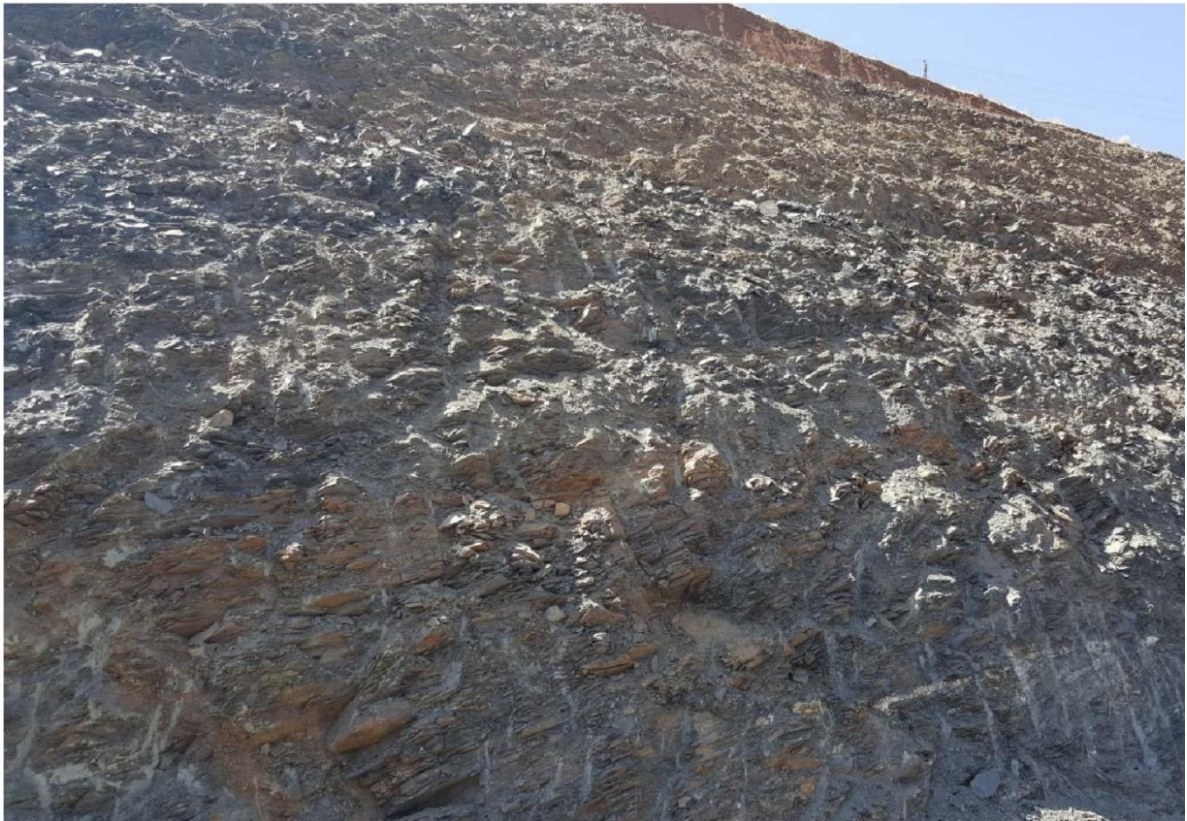
شکل ۱-۱۵۴: بهم‌ریختگی شدید مصالح و حضور سنگ‌های رسوبی (شیل و شیست) با لیتولوژی سست و بافت شیستوز در ساختگاه ترانشه‌های مورد مطالعه در کیلومتر ۲۰۰+۶ تا ۳۵۰+۶ از سمت اسدآباد
